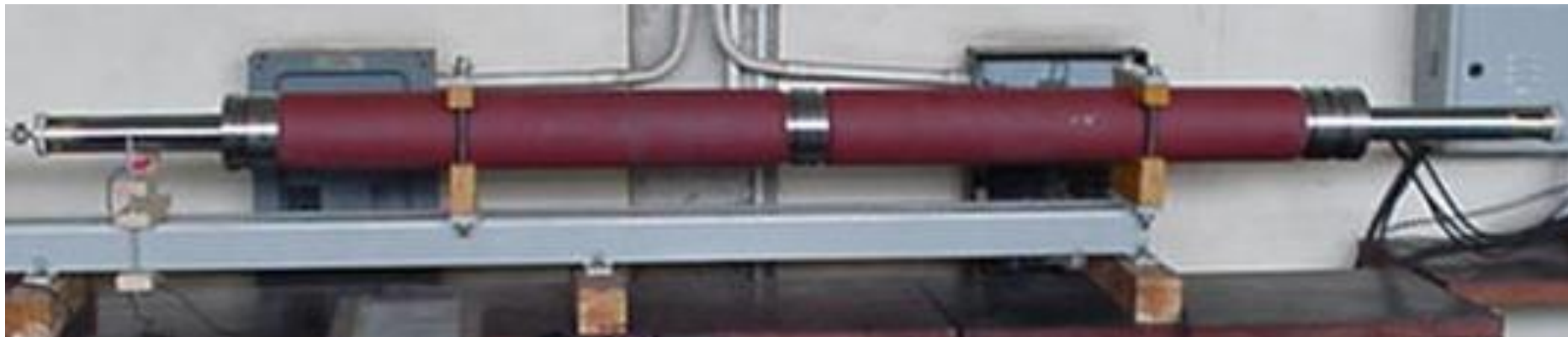
MOTOR TUBULAR APLICADO NO ACIONAMENTO DE BOMBA ALTERNATIVA
