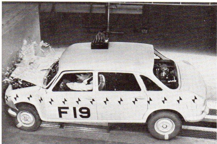
IMPULSO DE VEÍCULO PARA TESTE DE “CAR CRASH”
