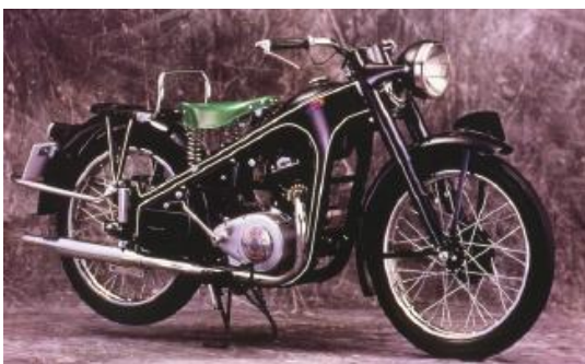
Figura 3.2.2.4: Honda Dream Type E, primeiro motor quatro tempos. Fonte: < http://www.motorera.com/honda/old/oldhonda.htm >, acesso em 3/2013.
