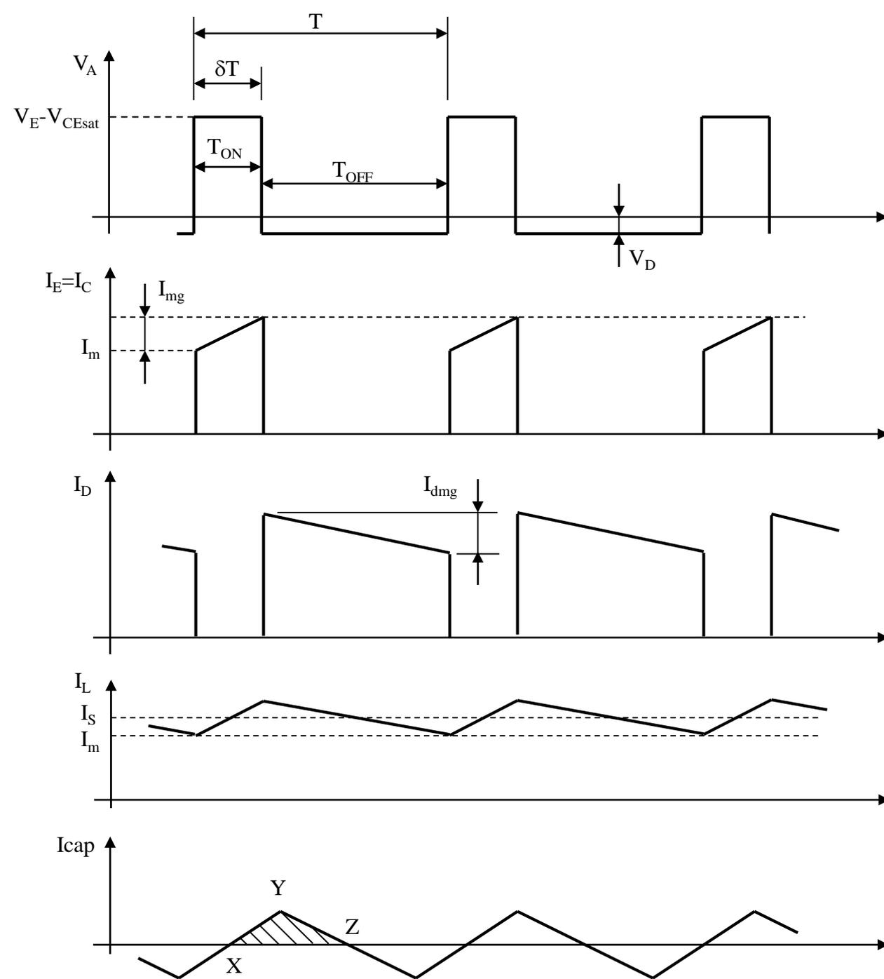
Quando o transistor é colocado em corte, para não haver interrupção na corrente pelo circuito, o indutor força a condução do diodo (conhecido como diodo de retorno, pois tem a função de prover caminho de corrente para o indutor durante o período de corte do transistor), fazendo a tensão no ponto A ficar fixa em -0,6 Volt. Neste trecho a corrente no indutor decresce fornecendo energia à carga de saída (corrente de desmagnetização).
