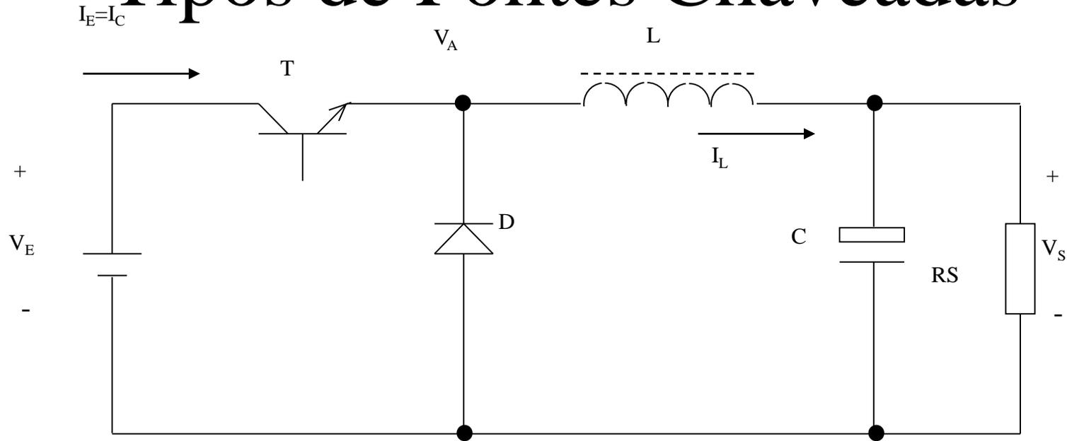
a) Buck, ou step-down, ou rebaixadora – produz uma tensão mais baixa que a original ( $V_S < V_E$ )
