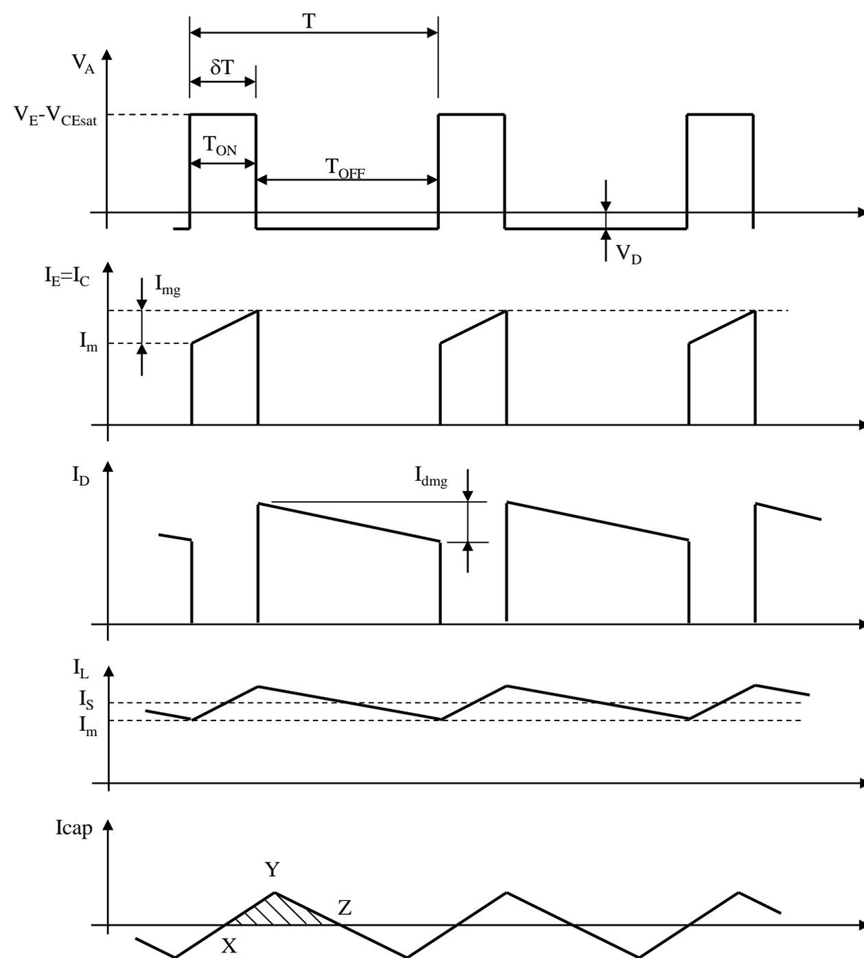
Quando o transistor conduz, no ponto A temos uma tensão ( $V_E - V_{CEsat}$ ) e temos o diodo reversamente polarizado. Há circulação de corrente pelo transistor e pelo indutor. A corrente no indutor cresce de um valor inicial não nulo até um valor superior, repondo a energia perdida durante o período em que o transistor esteve cortado (corrente de magnetização).
