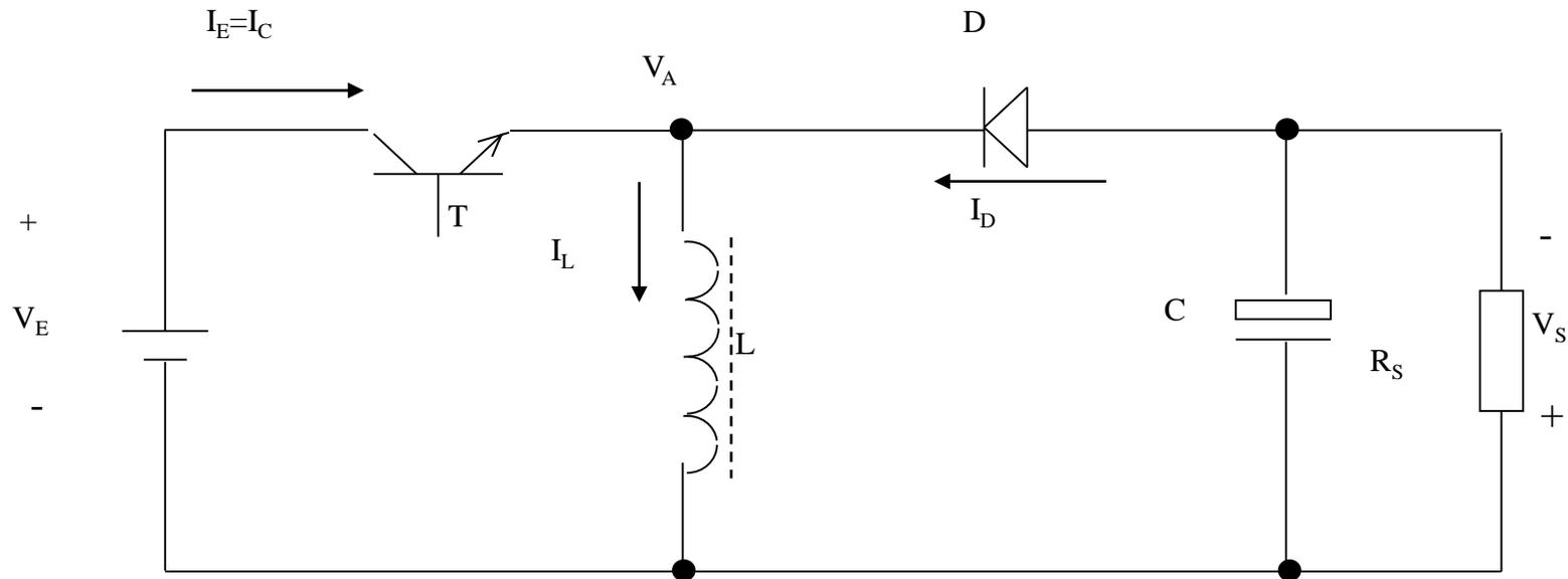
c) Buck-Boost, ou inversora – produz uma tensão com polaridade invertida com referência à original
