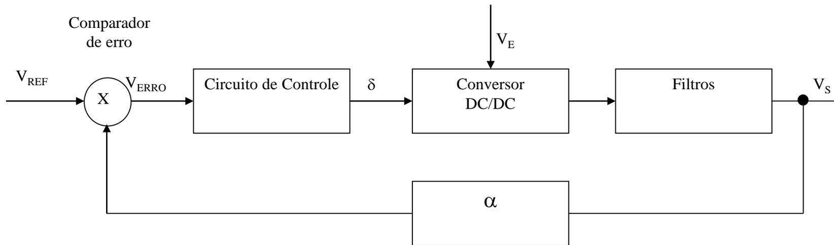
No diagrama de blocos de um circuito de controle PWM. A parcela da tensão de saída  $\alpha V_s$  é comparada com a tensão de referência  $V_{REF}$  para obter o sinal de erro  $V_{erro}$  que por sua vez controla a largura de pulsos  $\delta T$  do oscilador PWM. No caso da tensão de saída desejada ser igual à tensão  $V_{REF}$ ,  $\alpha$  é igual a 1.
