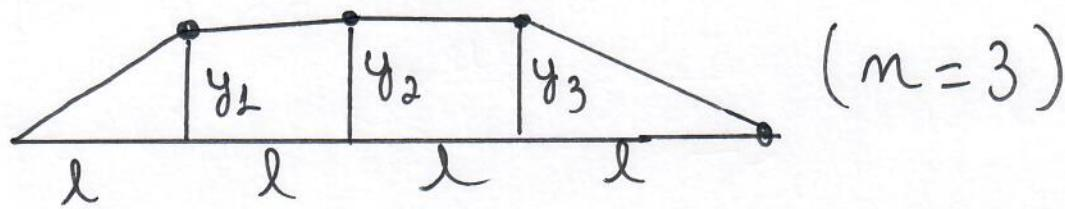
As coordenadas generalizadas para o problema são os deslocamentos  $y_1, y_2, \dots, y_n$  e a energia cinética é:  $T = \frac{1}{2}m (\dot{y}_1^2 + \dot{y}_2^2 + \dots + \dot{y}_n^2)$
