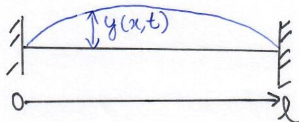
Vamos estudar pequenas oscilações transversais da corda. Em lugar um conjunto finito de coordenadas generalizadas, temos uma função contínua, o deslocamento  $y(x,t)$  da corda a partir de sua posição de equilíbrio. Vamos introduzir a seguinte notação:
