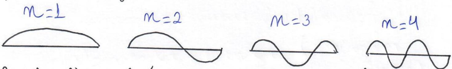
A solução geral é uma superposição de todos os modos. Para conectarmos com a solução geral obtida anteriormente
