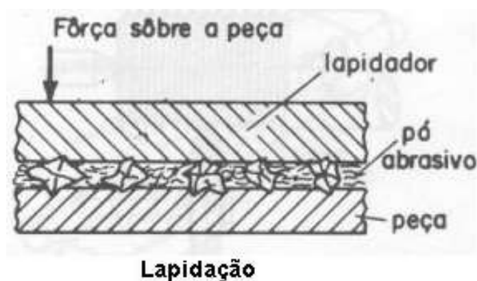
Figura 2.19 - Esquema de operação de lapidação com sua terminologia.
