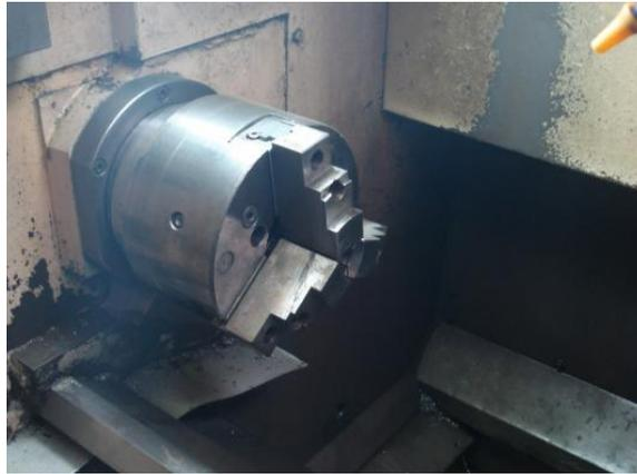
Figura 3 - Placa de fixação da peça em um torno CNC (seu fechamento é automático e pode ser comandado por programa)
