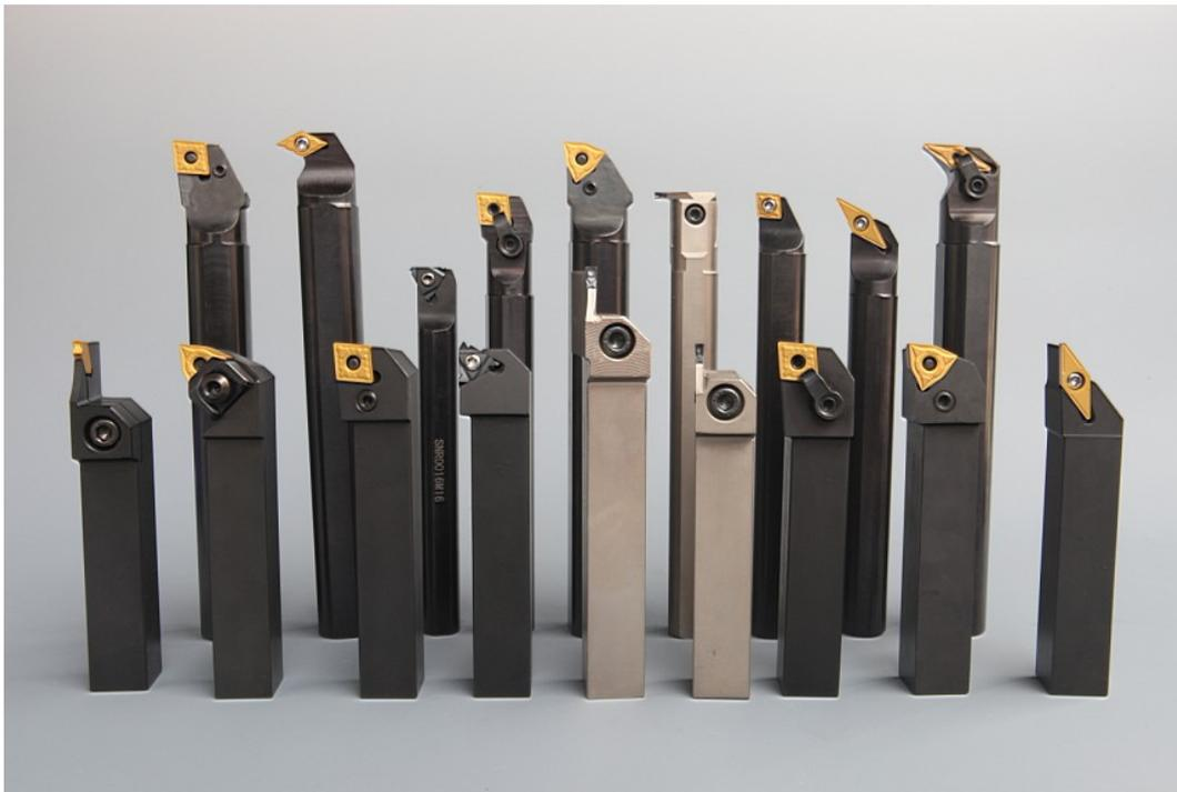
Figura 6 – Diversos tipos de suporte de ferramentas para tornos CNC
