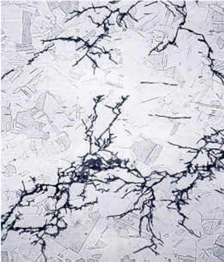
Modo Transgranular de Fratura
