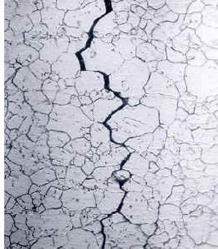
Modo intergranular de fratura
