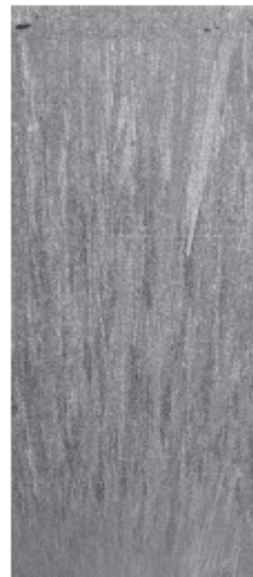
Macrografia da peça extrudada (seção longitudinal)
