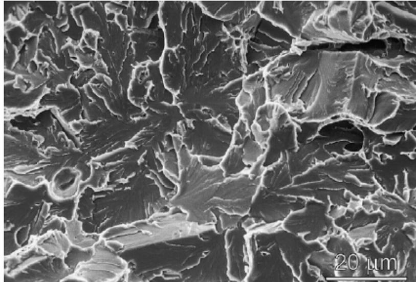
Figura 3 – Exemplo de fratura de um aço, ensaiado à  $-130^{\circ}\text{C}$  (Hadraba et. al., 2008).
