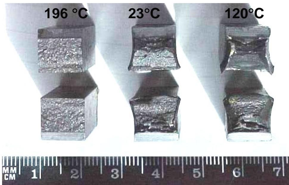
Figura 5 – Fraturas de amostra de aço resultantes de um ensaio de impacto em diferentes temperaturas.
