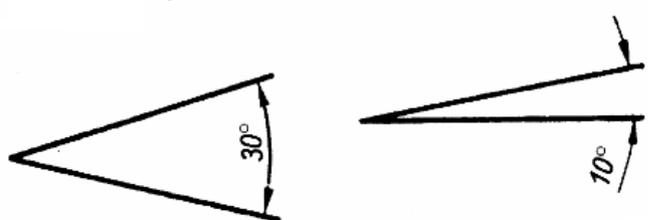
d) Quando o ângulo for muito fechado, podem-se marcar os graus conforme mostra a figura.
