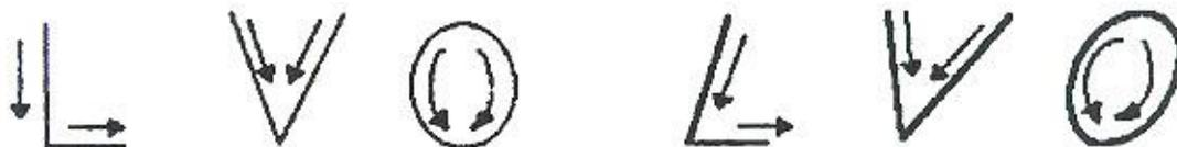
Utilizam-se letras maiúsculas e minúsculas, e podem ser traçadas de forma vertical ou inclinada.
