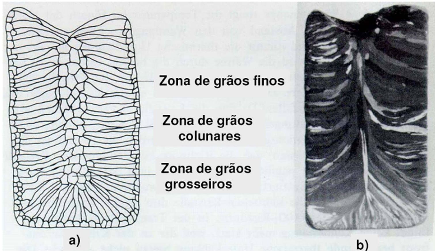
Figura 4.2 – Zonas de cristalização em um lingote fundido. a) representação esquemática das três zonas; b) Crescimento colunar exagerado dos grãos em Zinco puro . Aumento: 2X (S. Riedel)
