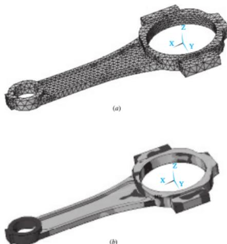
Figura : Modelo por MEF: (a) malha; (b) tensões [4]
