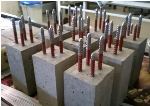
Figura 1.1 – Peças de concreto para os ensaios de corrosão da armadura (as novas tem apenas três hastes)
