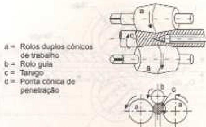
**Definição:** Neste processo de conformação a quente, uma seção oca é formada através da rotação periférica de um tarugo contra um mandril com ponta. O tarugo é movido por um par de rolos cônicos montados com eixos longitudinais reversos. A força de atrito entre os rolos e o tarugo produz movimentos de rotação e avanço longitudinal do tarugo contra a ponta do mandril.
