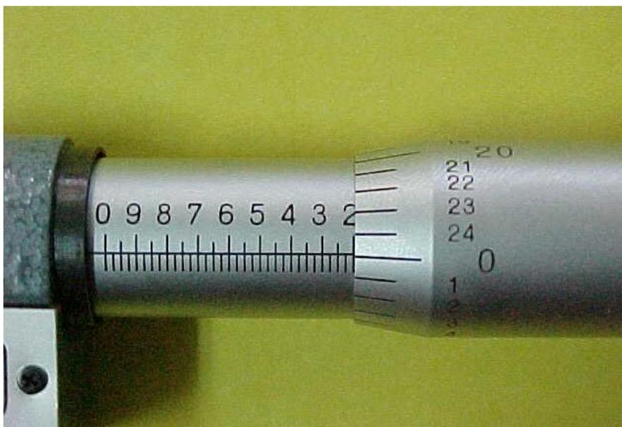
Figura 3.3 – Parafuso micrométrico graduado de um micrômetro simples.
