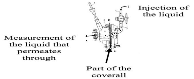
Fig. 10. The permeation test EN 374-3-2004.
