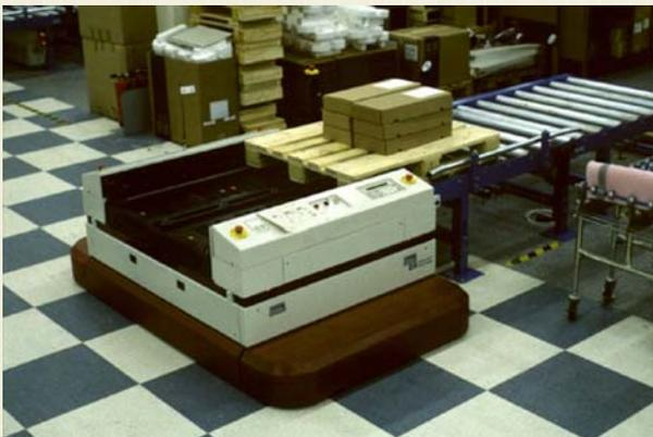
AGVs em operação de carga/descarga
