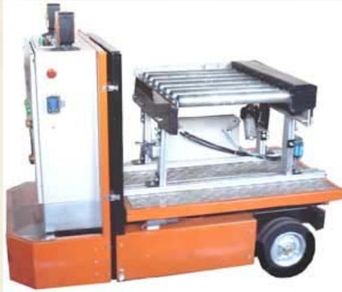
AGVs com passadeira de rolamentos para carga/descarga automática
