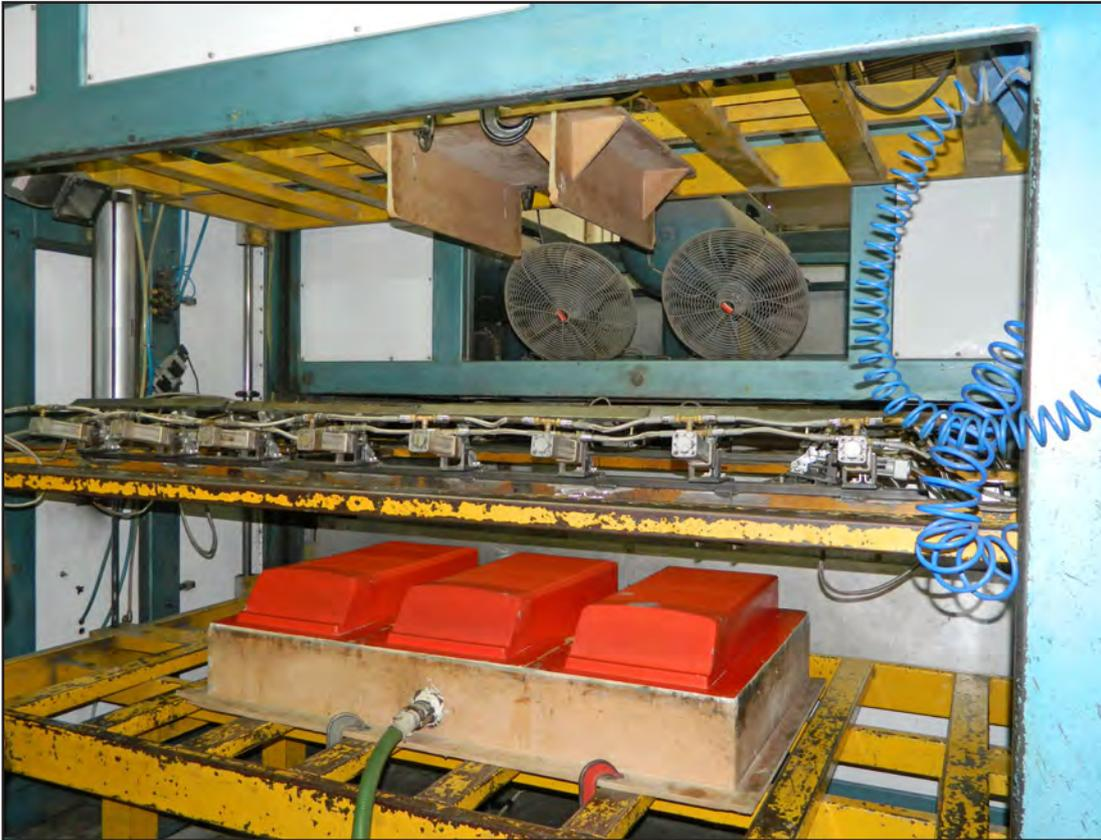
Figura 21 - Termoformação a vácuo
