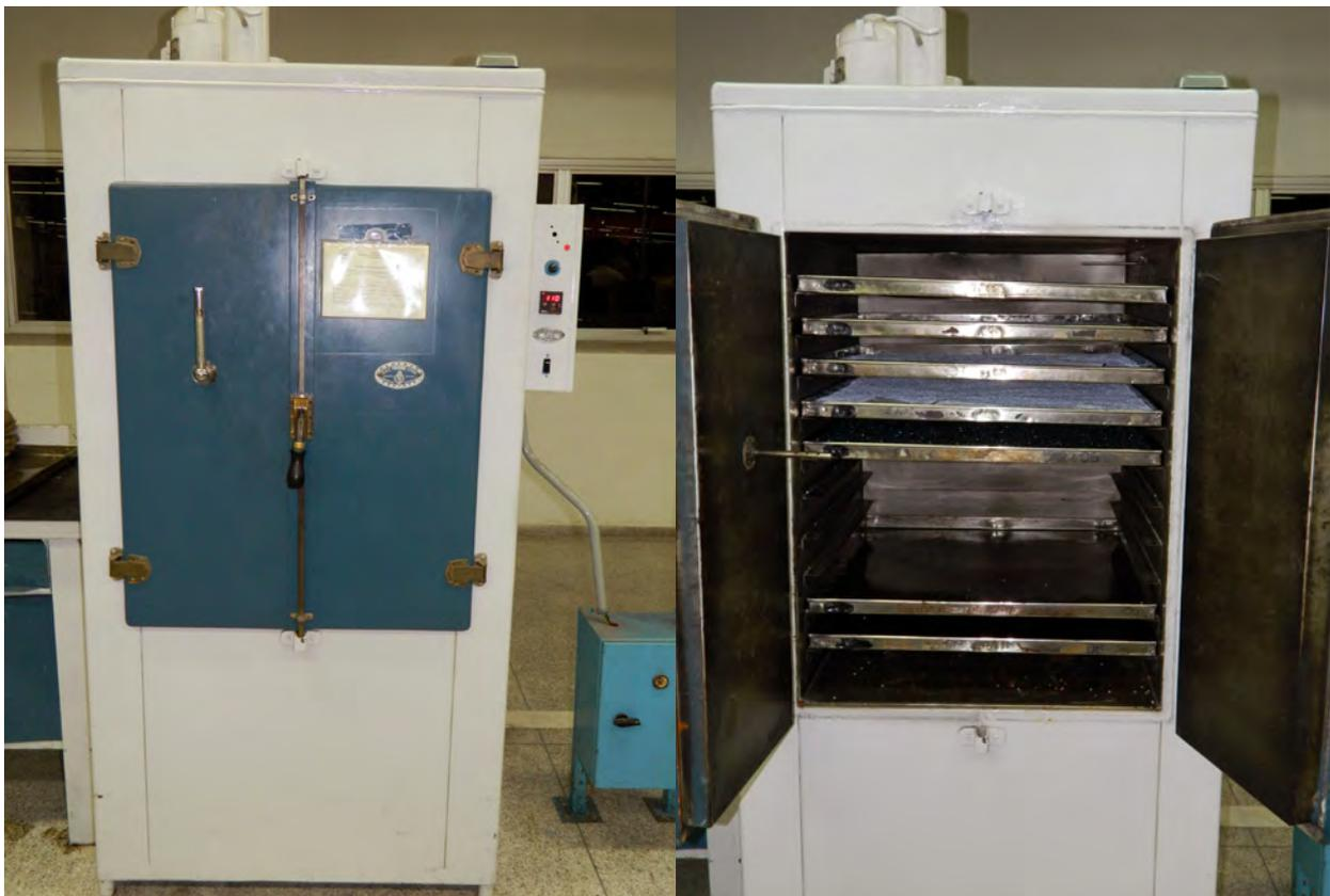
Figura 4 - Equipamento de estufagem de plástico.
