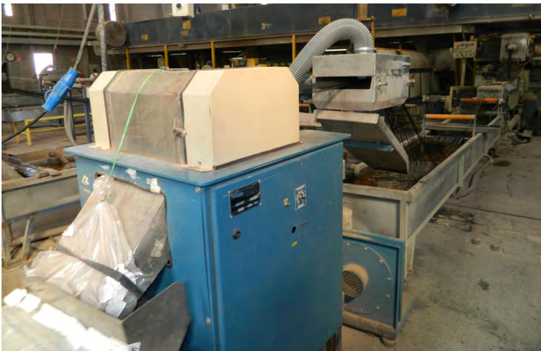
Figura 34 - Granulação com rotor de contra-facas
