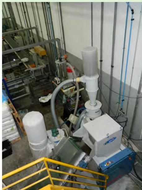
Figura 45 - Dosador e alimentador automático
