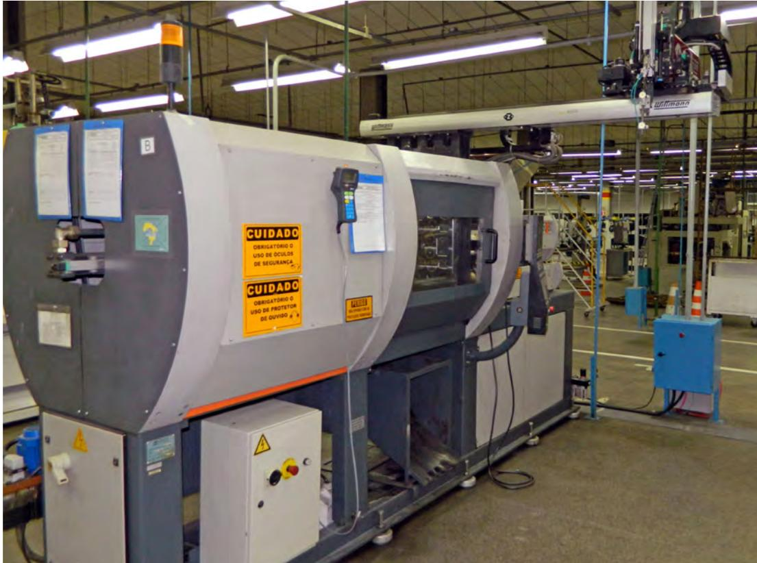
Figura 6 - Injetora de plásticos com manipulador
