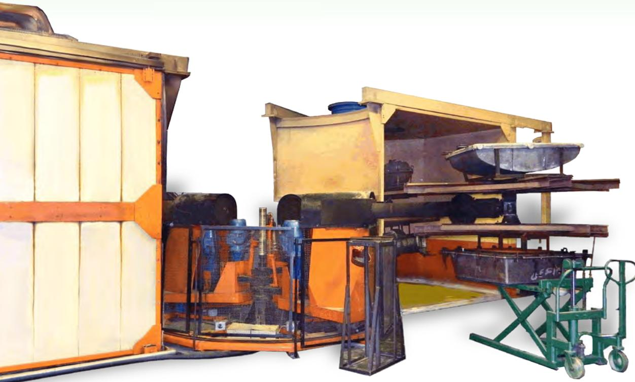
Figura 19 - Máquina de rotomoldagem
