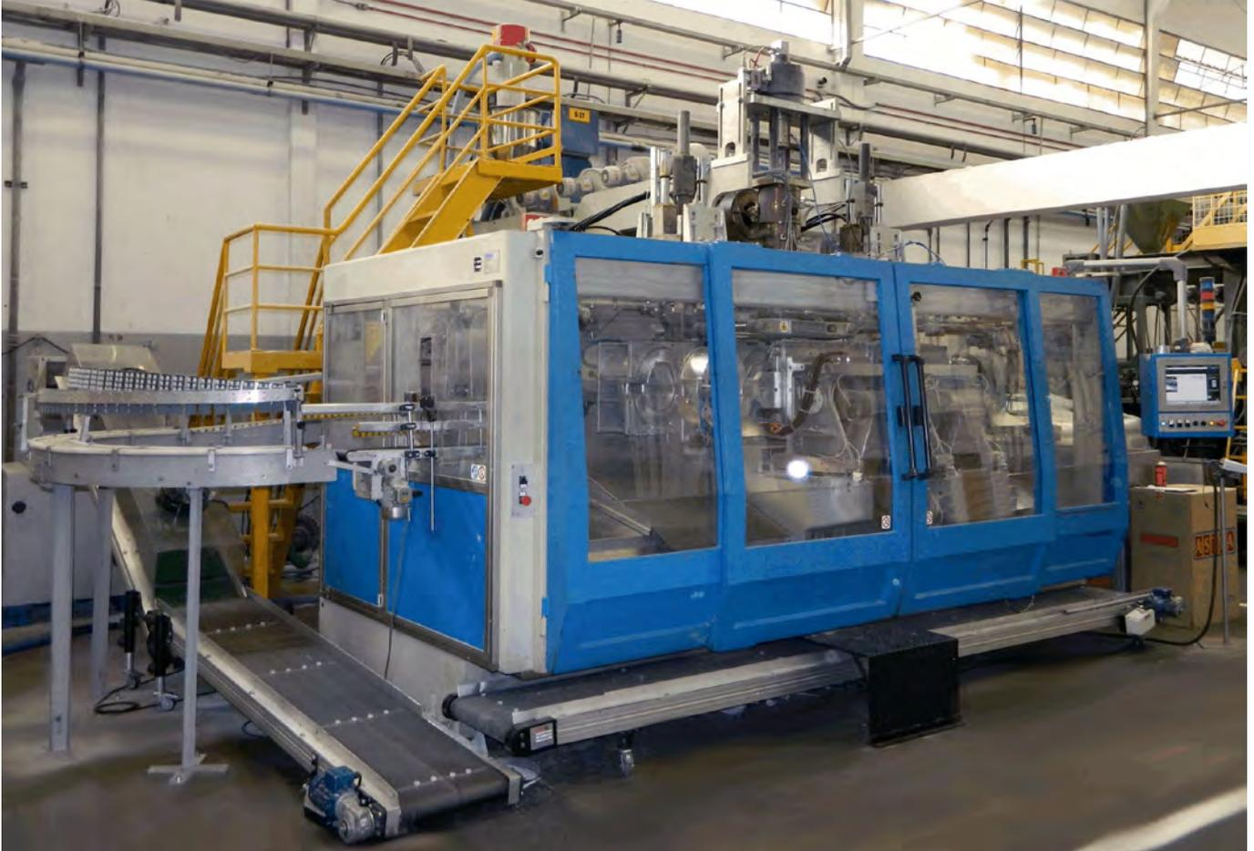
Figura 15 - Máquina sopradora
