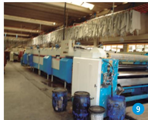
**Foto 7** Máquina da seção de rebaixadeiras – rebaixamento dos couros recém-curtidos ao cromo (*wet-blue*), para ajuste de sua espessura
