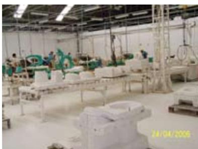
Figura 10 - preparação dos moldes
