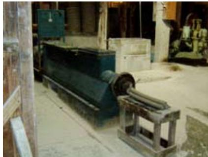
Figura 16 e 17 - Processo de extrusão de massa cerâmica
