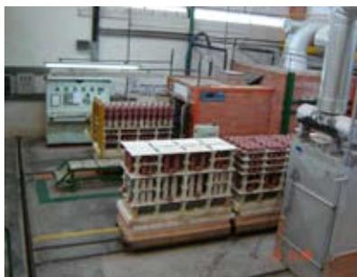
Figura 32 - carregamento de forno túnel
