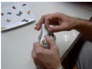
Figura 28 - aplicação de decalque
