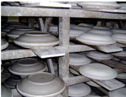
Figura 21- peças montadas para secagem
