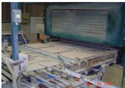
Figura 22 - peças na entrada de secador vertical
