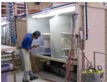
Figura 26 - aplicação de esmalte por pulverização
