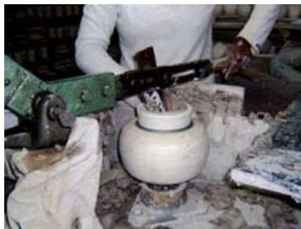
Figura 18 e 19 - Torneamento de peças cerâmicas
