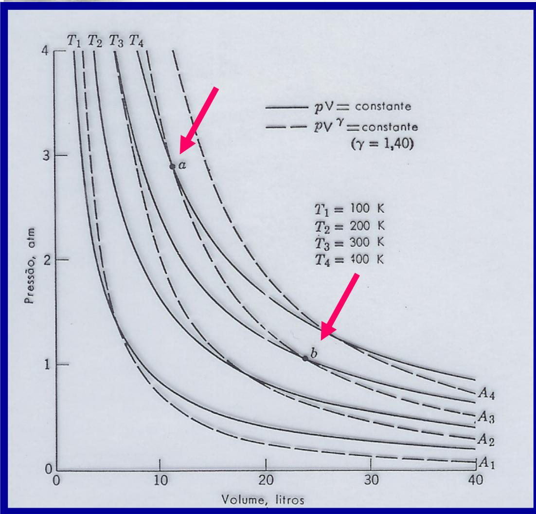
T1, T2 e T3 indicam como a pressão de um mol de gás varia com a variação de seu volume, mantendo-se constante sua temperatura (transformação isotérmica). A1, A2 e A3 representam a variação da pressão de um gás ideal como função de seu volume, sem troca de calor (transformação adiabática). Um aumento adiabático de volume (por exemplo, de a para b ao longo de A3) é sempre acompanhado de um decréscimo de temperatura, desde que, em a,  $T_4 = 400 \text{ K}$  enquanto em b,  $T_3 = 300 \text{ K}$ .
