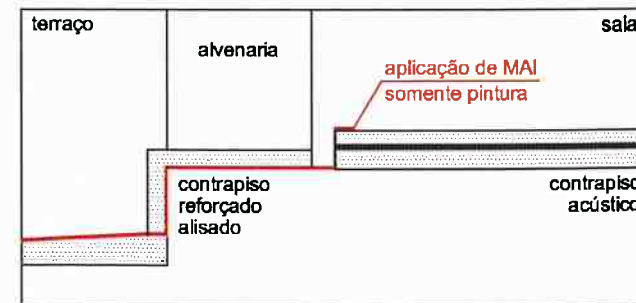
2.1 - execução do contrapiso reforçado alisado no terraço 2.2 - execução de MAI sobre o contrapiso do terraço e a sala 2.3 - execução do contrapiso reforçado alisado na área da soleira
