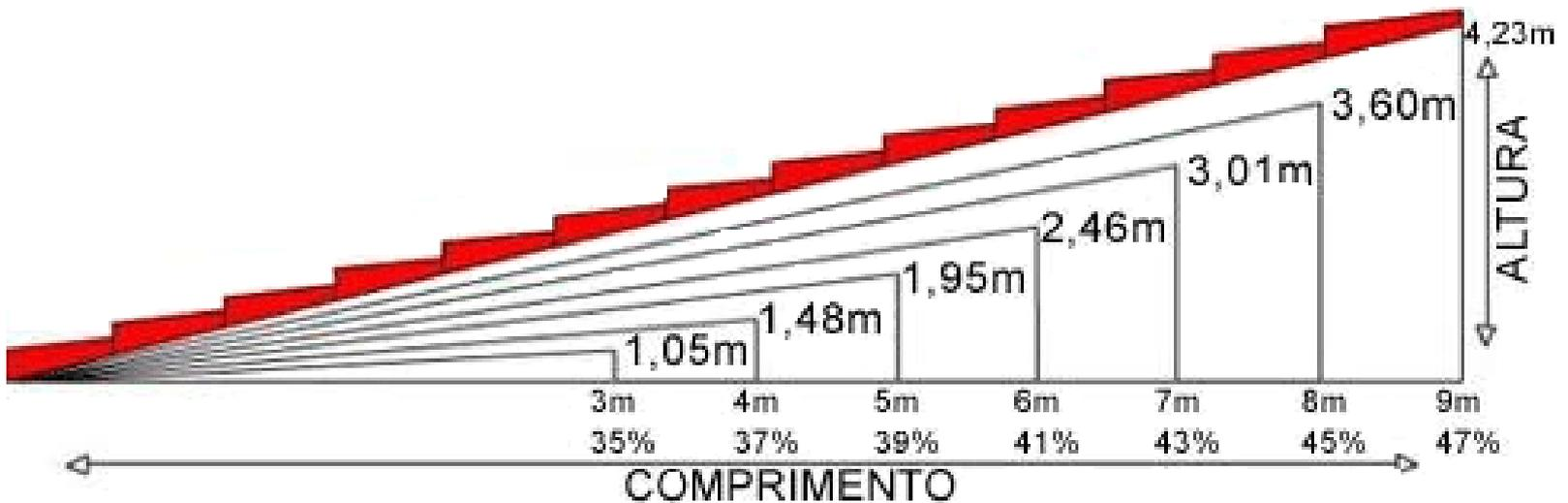
**Dimensionamento da inclinação das telhas de
