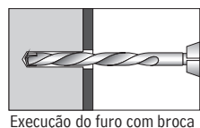
Execução do furo com broca
