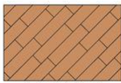
2 - Diagonal simples (juntas aleatórias)
