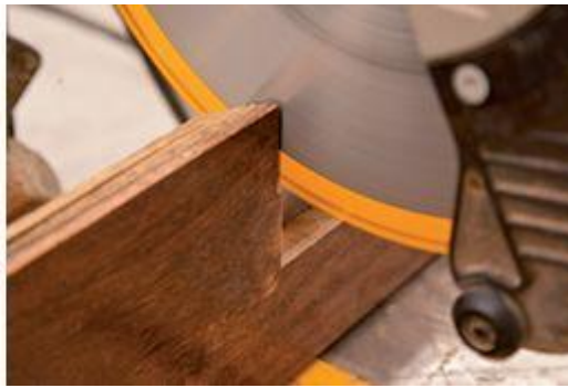
Marcação e recorte do revestimento de madeira
