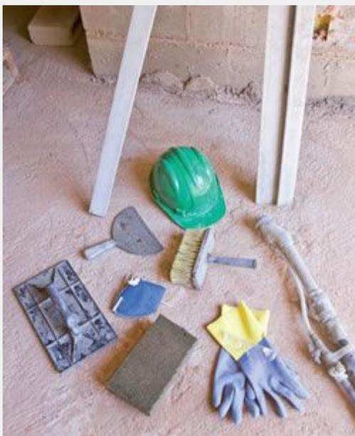
**Capacete, luvas, máscara, régua metálica e tipo H para sarrafeamento, broxa, desempenadeira plástica, esponja de espuma rígida e pistola do equipamento.**
