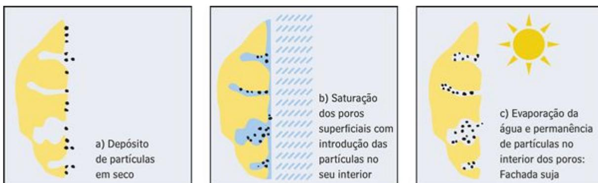
**Figura 3** - Esquema de escurecimento da fachada por sujidade com efeito da umidade
