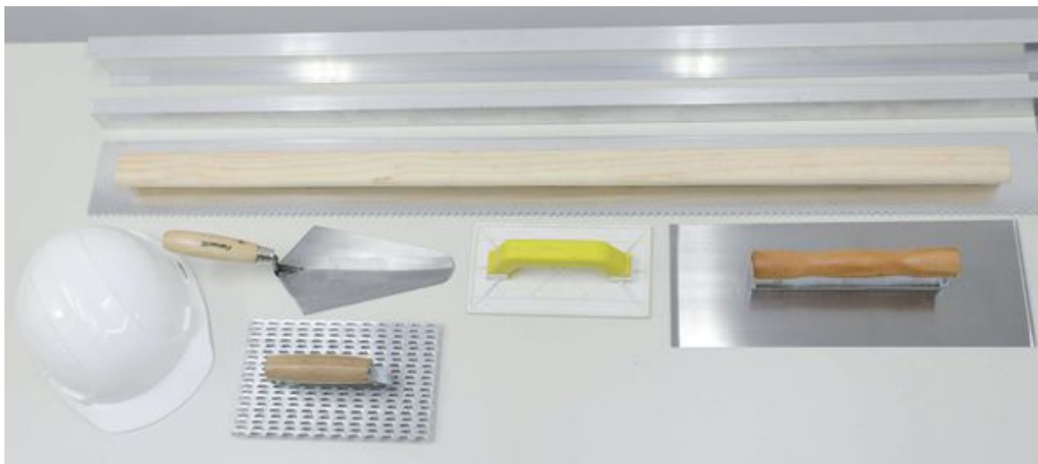
Figura 1 - Ferramentas necessárias para a aplicação do revestimento monocamada como argamassa decorativa
