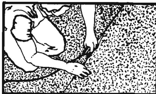
FIGURA 6.2.5 - Execução da emenda entre duas mantas adjacentes para os revestimentos tipo "tufts" [Fonte: SOMMER]; (a) posicionamento da fita termocolante e das mantas antes da aplicação do ferro quente; (b) execução da junta entre mantas com a passagem do ferro sobre a fita termocolante.
