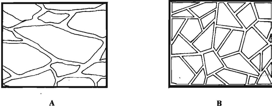
FIGURA 4.1.2 - Exemplos de disposições de juntas entre componentes de ardósia para execução de revestimentos de piso.
