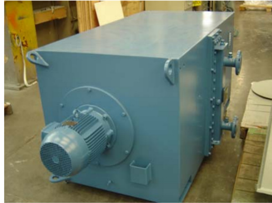
Figura 8.9a. - Trocador de calor ar-água. O movimento do ar interno do motor, através do trocador, é movimentado pelo ventilador montado no motor auxiliar do trocador.
