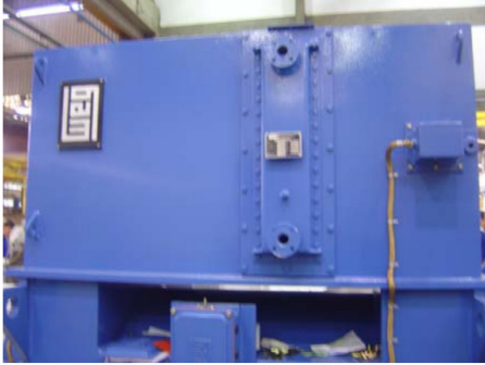
Figura 8.9a. - Trocador de calor ar-água. O movimento do ar interno do motor, através do trocador, é movimentado pelo ventilador montado no eixo do motor.
