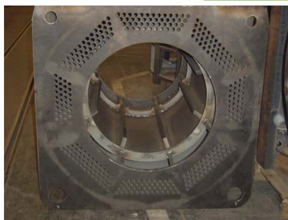
Figura 8.8b. - Trocador de calor ar-ar montado em volta do estator.
