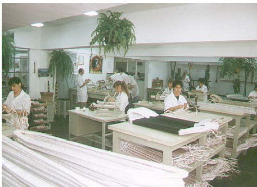
Figura 8.13a. - Laboratório de bobinagem de alta tensão, fabricação e isolamento das bobinas (cabeça de bobina).
