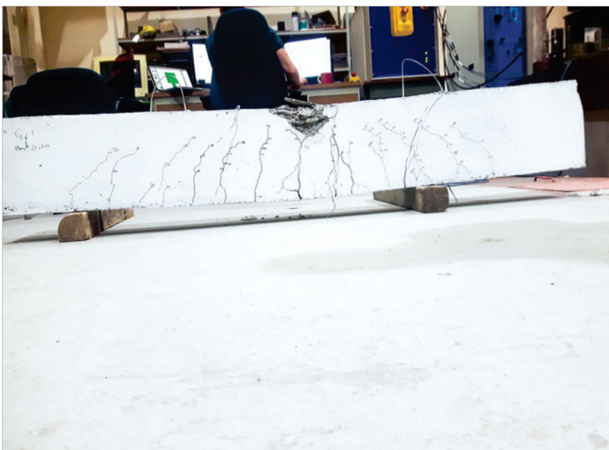
► Figura 3 Viga ensaiada na disciplina: com estribo, ruptura por flexão
