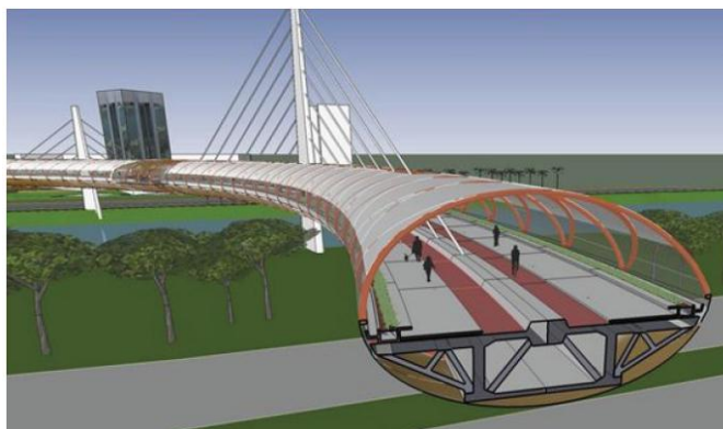
Figura 7-10 - Ilustração do corte vertical da ciclop passarela[82]
