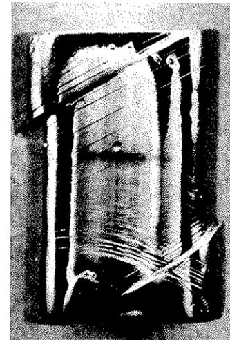
Figura 6: (a) Tensão cisalhante resolvida e (b) monocristal de Nb comprimido [7].
