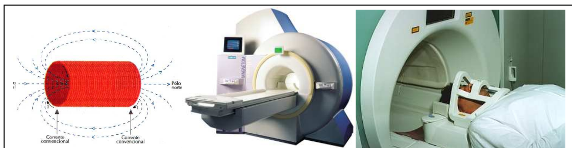
Figura 5 – O magneto principal do equipamento é um eletroímã produzido com material supercondutor, que gera um campo paralelo ao seu eixo interno, com maior homogeneidade no seu centro, onde o paciente deve ser posicionado. Os aparelhos mais antigos são mais estreitos e longos, com os modernos sendo mais curtos e amplos. À direita um paciente está com uma bobina receptora ajustada para o estudo da região cervical. A abertura do equipamento dá uma idéia do espaço que o paciente terá no interior do magneto.
