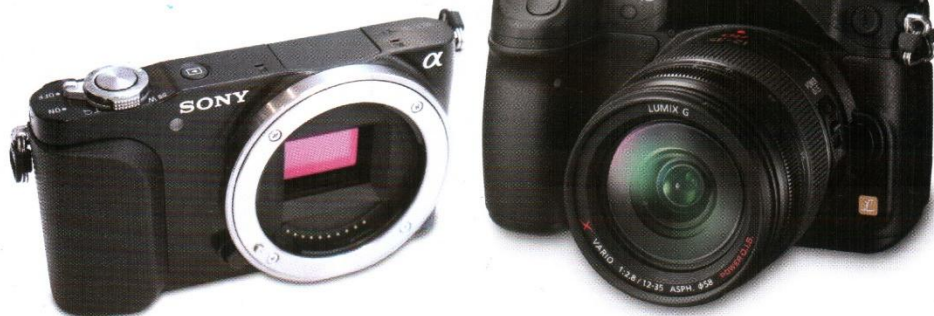
Acima, dois modelos mirrorless : a Sony NEX (à esq.) usa sensor APS-C; a Panasonic GH3 (à dir.) usa sensor Micro Quatro Terços
