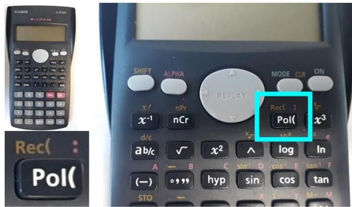
Figura 17 - Função Rec para cálculo de coordenadas retangulares.
