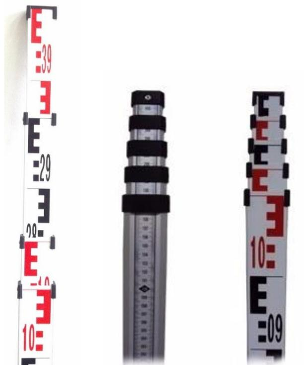
Figura 4 - Exemplos de régua graduada (taqueométrica ou estadimétrica).
