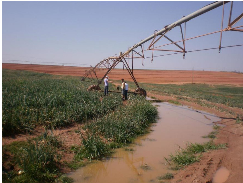
Figura 6 – Perda de solo devido ao mal dimensionamento do sistema de irrigação. Fonte: Agrimanagers.
