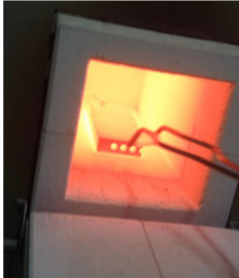
Figura 5.1: Corpo de prova sendo levado ao forno. Fonte: Acervo Pessoal
