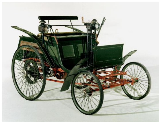
Figura 2.4: Benz Velo 1875 – Primeiro veículo com freio de mão tipo Band Brake.
