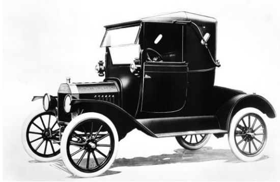
Figura 2.5: Modelo T de Henry Ford – Primeiro veículo produzido em série no mundo, equipado com freio a tambor.
