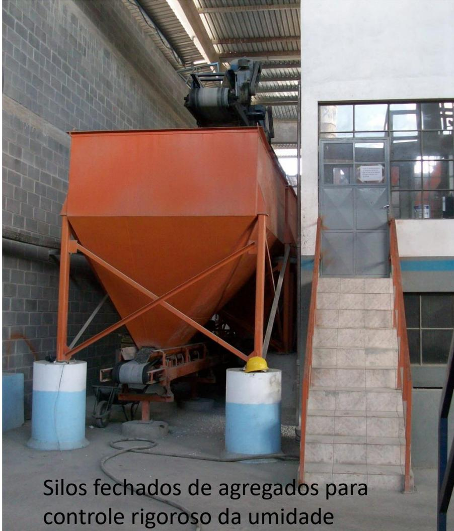
Silos fechados de agregados para controle rigoroso da umidade
