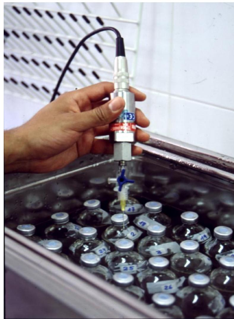
Adaptação do sistema de THEODOROU et al. (1994) para determinar a produção de gás por pressão
