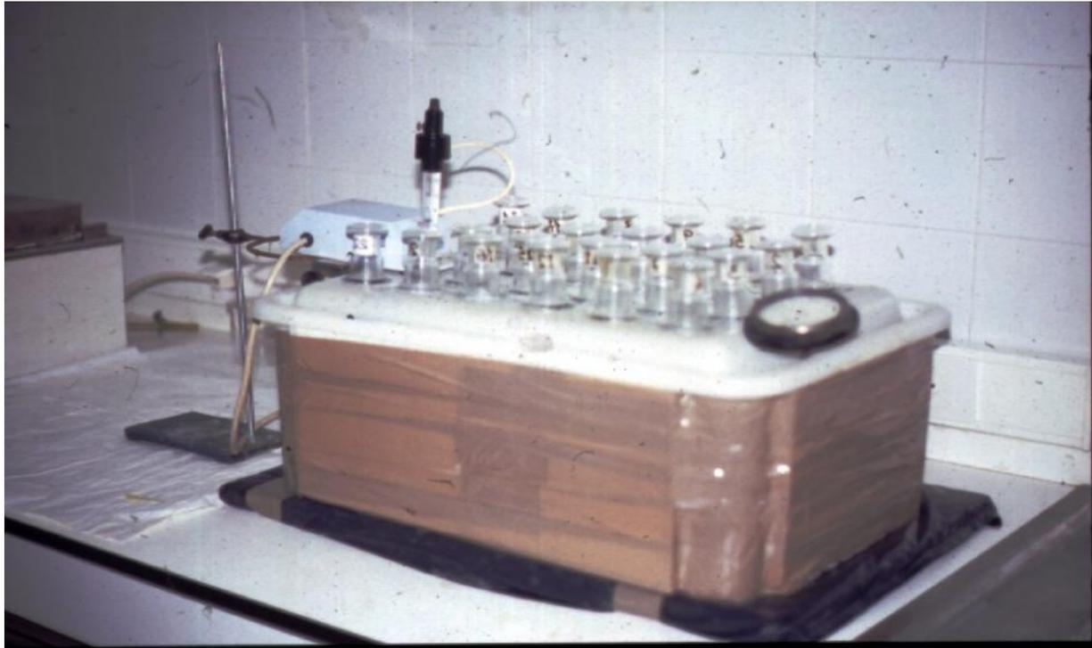
Adaptação do sistema de MENKE & STEINGASS (1988) para determinar a produção de gás por volume
