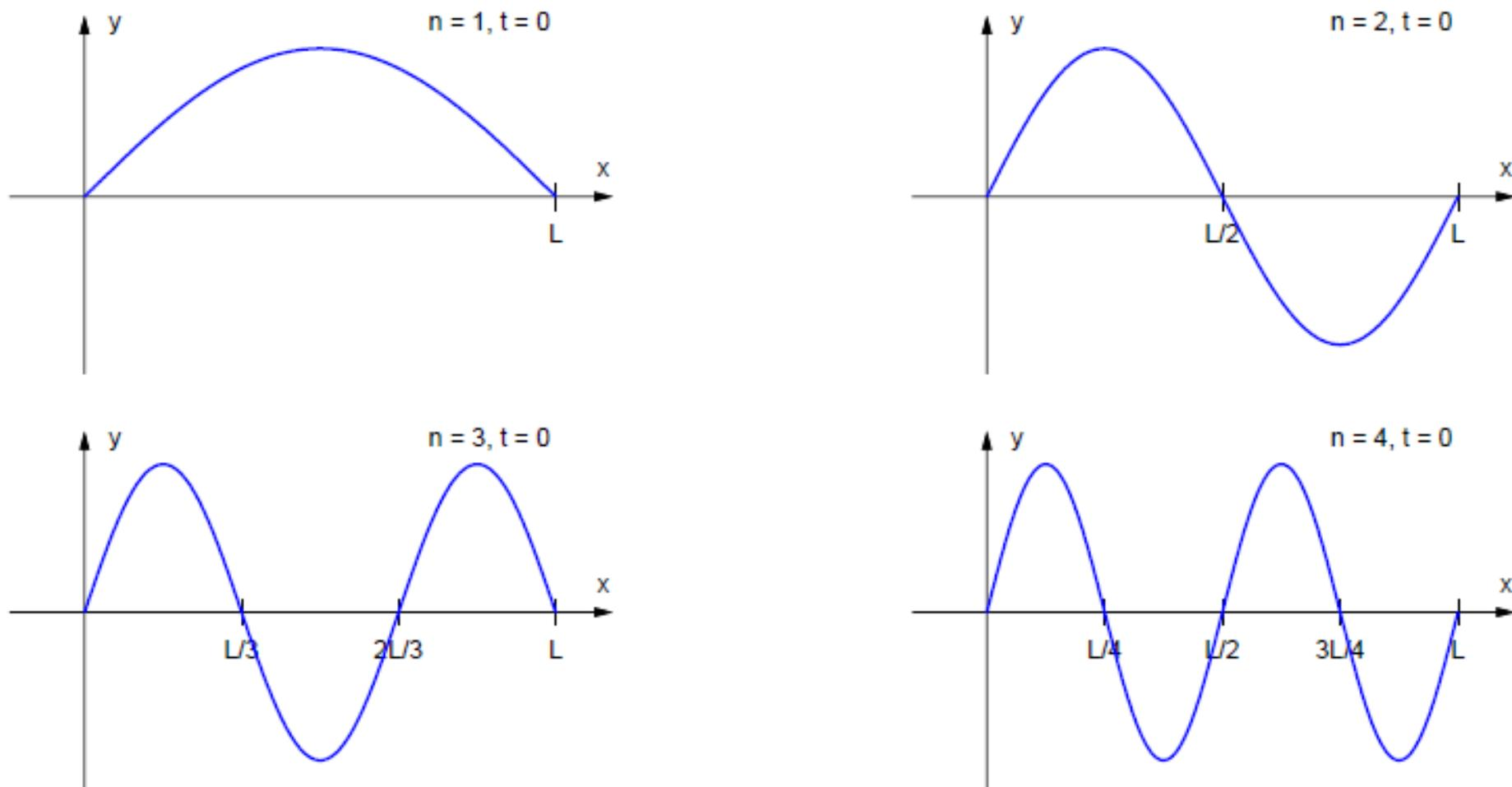
Figura 4.1 – Modos naturais de vibração  $u_n(x, t) = \cos \frac{an\pi t}{L} \text{sen} \frac{n\pi x}{L}$ , para  $n = 1, 2, 3, 4$  e  $t = 0$ .
