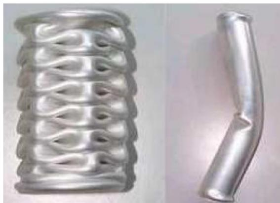
**Figura 7. Flambagem (a) progressiva e (b) global**
