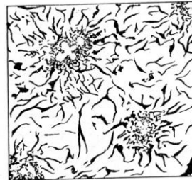
Fig. 535 — Veios de grafita do tipo B. Veios com disposição radial em torno de nódulos de aspecto esférico. 100 x.
