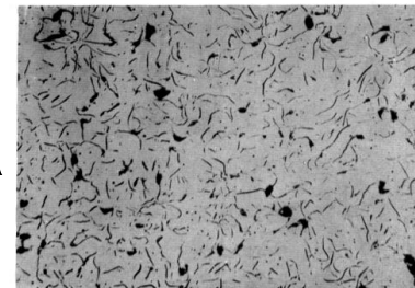
Fig. 542 — Ferro fundido cinzento com grafita do tipo E. 100 x.
