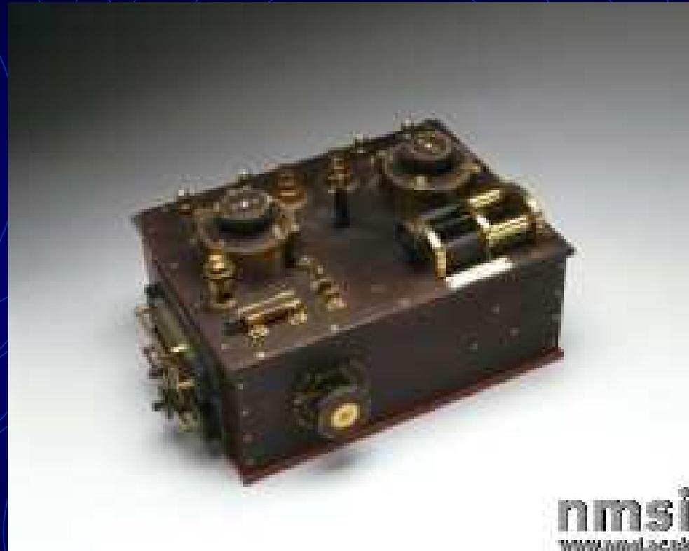
Receptor de rádio, usando a válvula de Fleming (1908)
