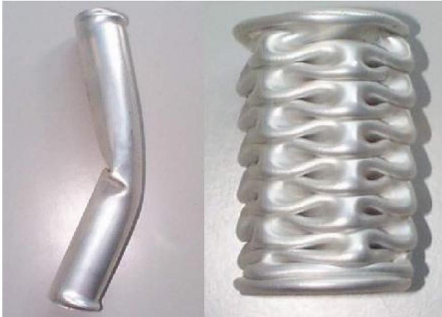
FIGURA 49: MODOS DE FLAMBAGEM DE TUBOS CIRCULARES<sup>16</sup>.
