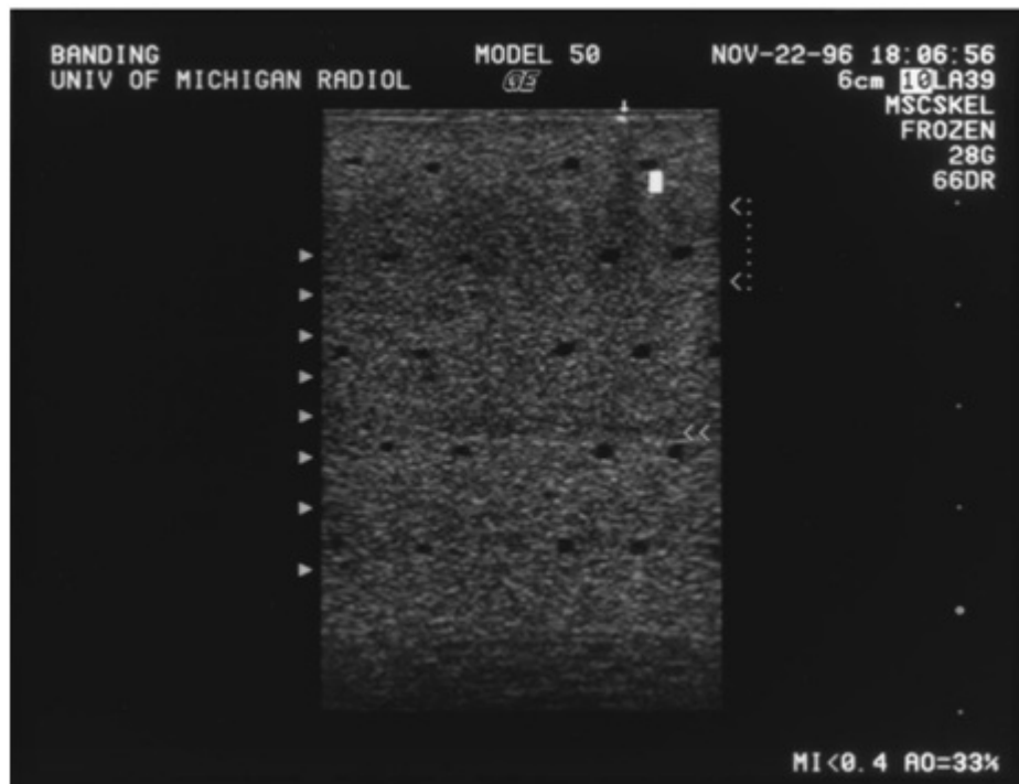
Figura 2: Exemplos de ranhuras. As listras horizontais são geralmente causadas por problemas de circuito e foco, enquanto que as listras verticais indicam danificações no transdutor.
