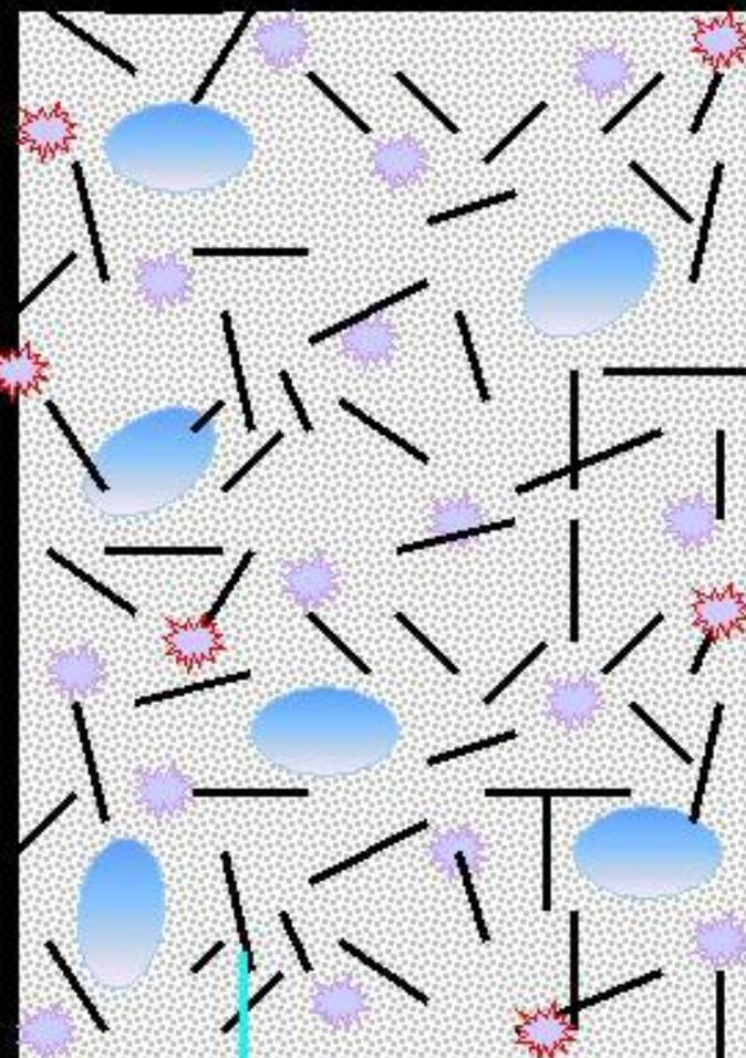
fibras de polipropileno fundidas permitem aliviar a pressão de vapor dos poros
