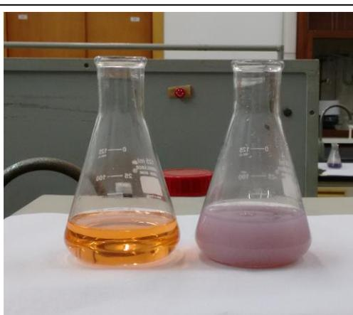
Solução problema contendo o indicador antes da titulação e no ponto de equivalência com precipitado em suspensão.
