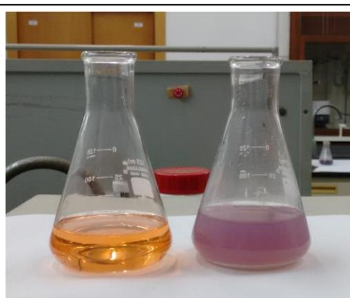
Solução problema contendo o indicador antes da titulação e no ponto de equivalência com precipitado parcialmente decantado (3-5 min).
