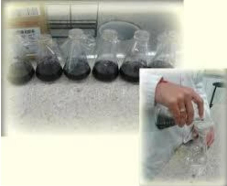
Para cada concentração, filtra-se a solução, tendo o cuidado de lavar inicialmente o papel de filtro com cerca de 25 mL de própria solução (o filtro adsorve ácido acético) que são descartados, só após filtrando o restante da solução.
