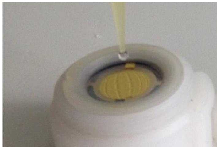
Sensor identifica presença de moléculas de antígeno em soro sanguíneo, fornecendo rapidamente resultado positivo ou negativo (foto: Cleverton Pirich)
