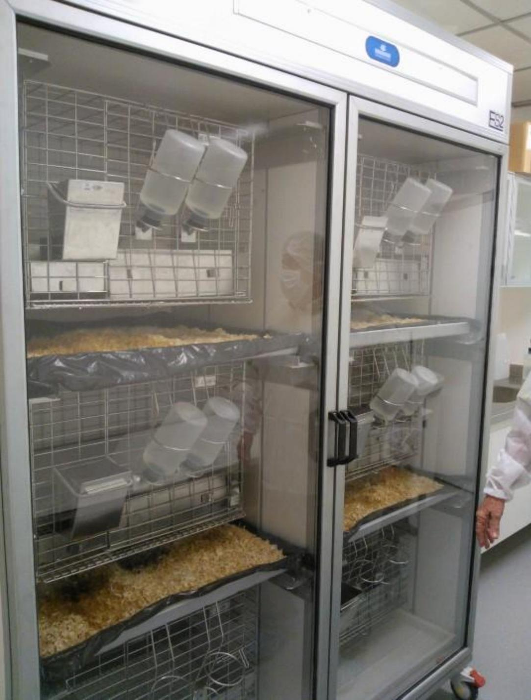
Estante ventilada para manutenção de animais inoculados (ar duplamente filtrado – entrada e saída, temperatura e umidade controlada).
